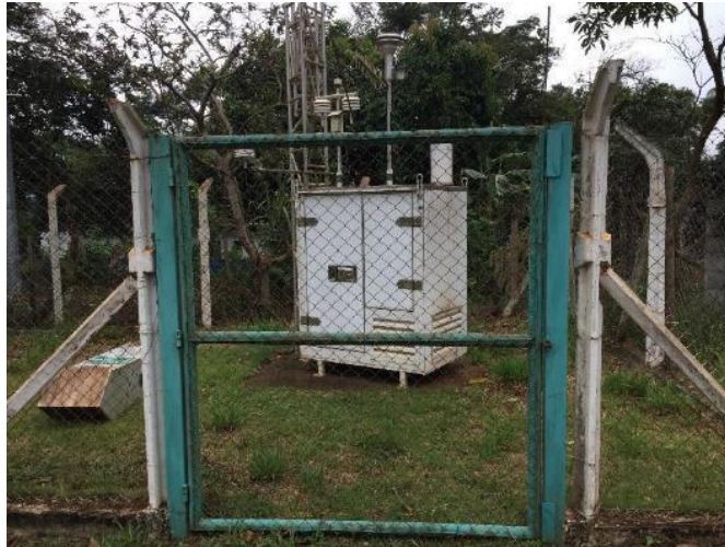
Foto 2-1: Estação automática de qualidade do ar – BAM1020 Met One.
