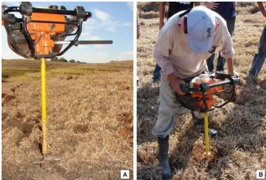
Foto 3-14: Aspecto de uma moto-coveadora (A) e abertura de cova com moto-coveadora (B).
